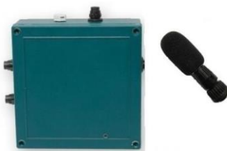
Figure 6 : Détecteur et enregistreur d'ultrasons SM2BAT + Wildlife
