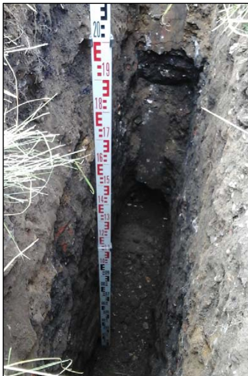
Photo 3 : essais à la pelle mécanique EM20 (à droite) et EM22 (à gauche) effectués dans l'horizon remblayé
