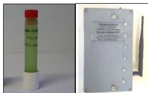
Figure 40 : Tube passif pour NO 2 et micro-capteur laser
