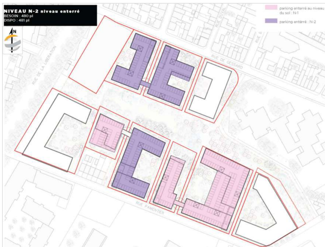
Figure 2 : plan des sous-sols au droit de chacun des lots (source : plans projet reçus à la consultation en juillet 2021, non datés non signés)
