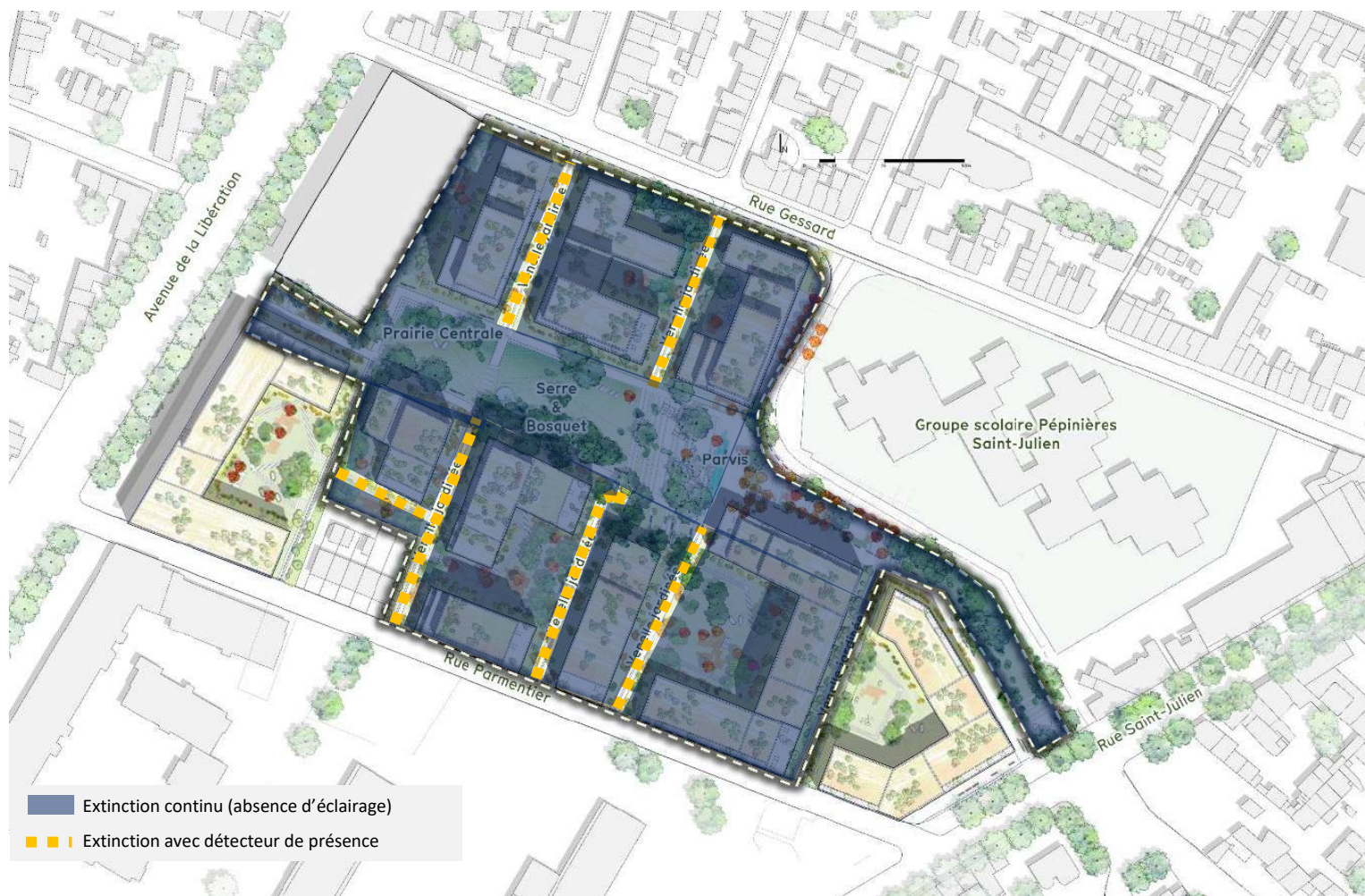
Figure 81 : Schéma d'éclairage adapté sur le plan masse © Altarea Cogedim, modifié par ARP-Astrance 2022
