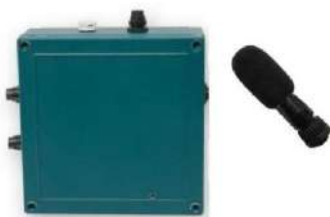
Figure 6 : Détecteur et enregistreur d'ultrasons SM2BAT + Wildlife
