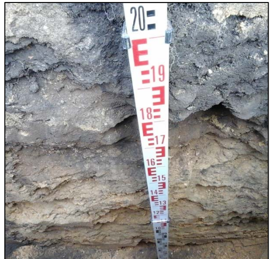
Photo 2 : essais à la pelle mécanique EM19 (à droite) et EM21 (à gauche) effectués dans l'horizon gravelo-sableux
