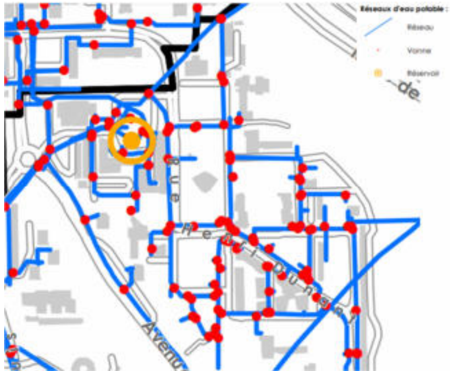
Plan des réseaux d'adduction en eau potable – ZAC Centralité Châtelet (Source : PLU Métropole Rouen Normandie)
