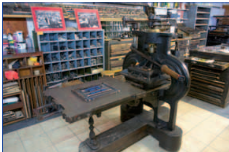
La presse Stanhope, mise au point en 1795, sera utilisée durant toute l'épopée de la typographie, notamment pour l'impression en relief jusqu'au début des années 1980.
