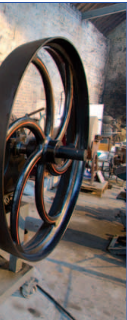
La Pompe Chevalet, qui doit son nom à sa forme, est une pompe à trois pistons, qui était fabriquée à Troyes.
