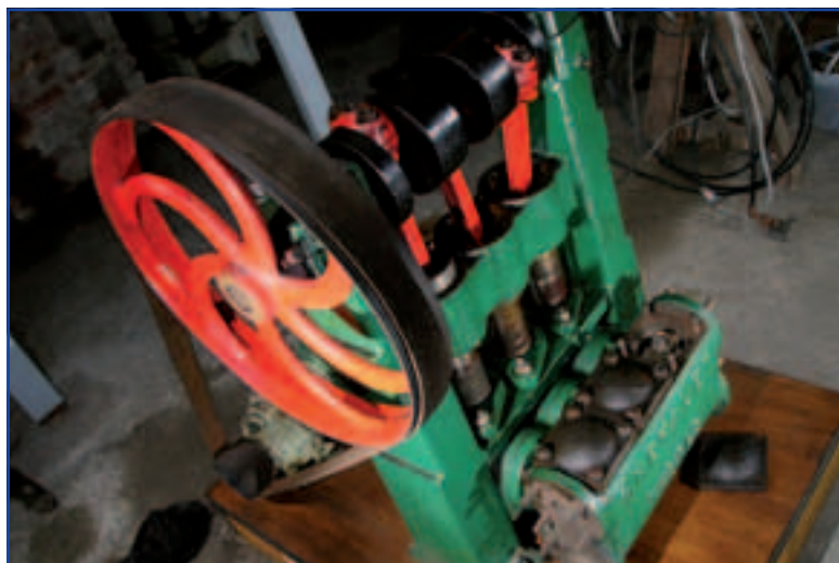
La Pompe Chevalet, qui doit son nom à sa forme, est une pompe à trois pistons, qui était fabriquée à Troyes.
