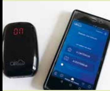
Lancé par deux Rouennais, le boîtier Airmatrix mesure la qualité de l'air et le taux de particules fines, où que l'on se trouve. Une simple connexion au Smartphone suffit pour visualiser la carte de la pollution.
